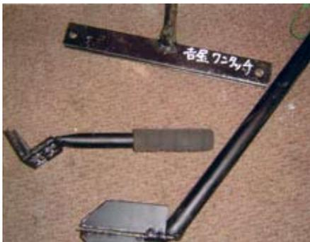
50のアングルの上に40のアングルを重ね側面を溶接し、パイプの平らにつぶした方を60度の逃を作って溶接し、ソフトグリップをセメダインスパイク等の接着剤で接着し完成。
